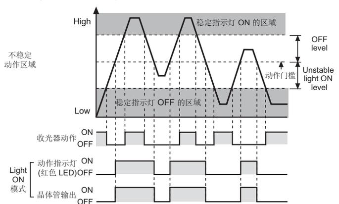
\* 当选择 Dark ON 模式时 '动作指示灯' 和 '晶体管输出' 的波形图与 Light ON 模式时相反。
