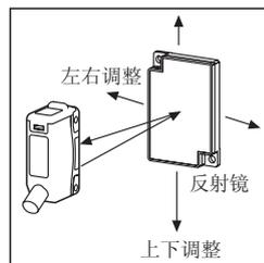
3. 固定后, 在两种情况下(有检测物 and 没有检测物)检查传感器的动作和指示灯的变化。
