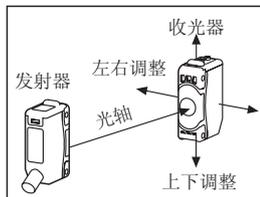
3. 固定后, 在两种情况下(有检测物 and 没有检测物)检查传感器的动作和指示灯的变化。
